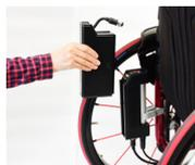
La batteria aggiuntiva estende l'autonomia del propulsore di 7 km, sostituendo rapidamente quella in uso.
